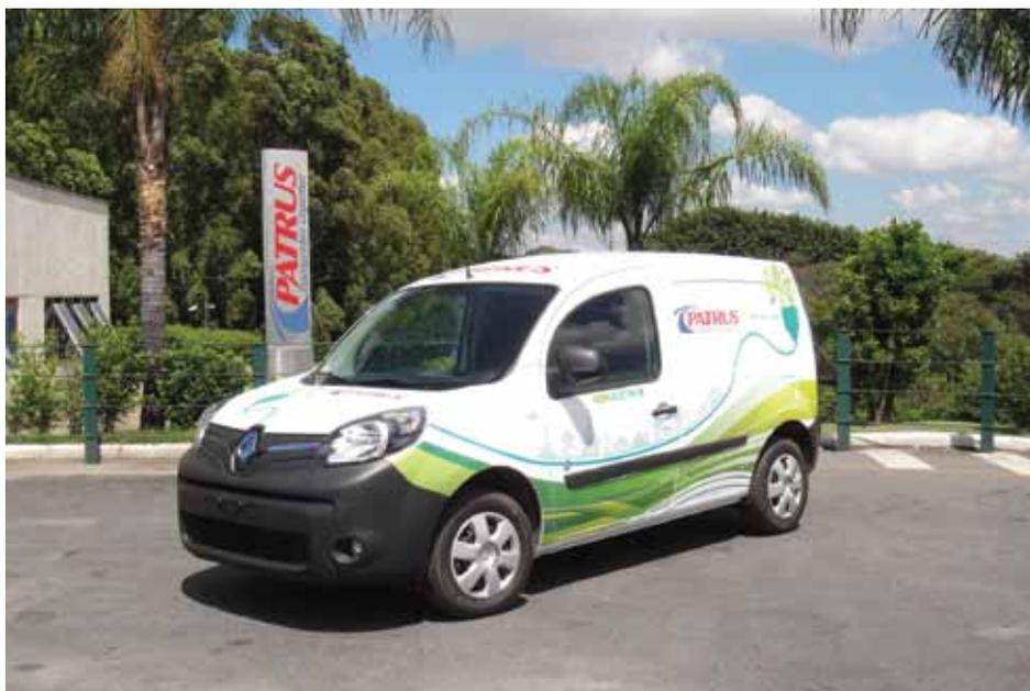
Veículo não emite poluentes na atmosfera e consome 3KVA/16A de energia para rodar 120 km
